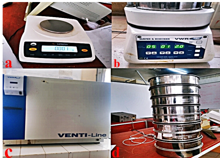
Photo 2: Appareils utilisés au laboratoire de physique et chimie des matériaux de l'Université Assane SECK de Ziguinchor (a : balance de précision, b : agitateur électrique des tamis c : étuve, d : tamis)
