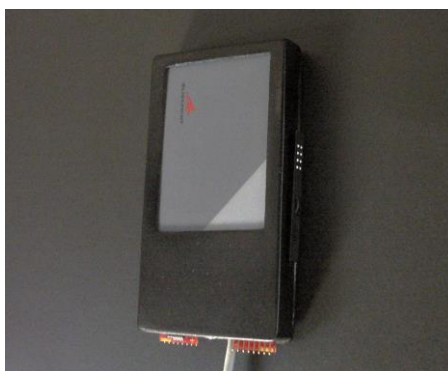
Figure 3 : Exemple de module d'interaction tactile composé d'un touchpad et de 8 picots (cellule braille piézoélectrique)
